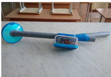
Фотография металлоискателя, собранного своими руками
